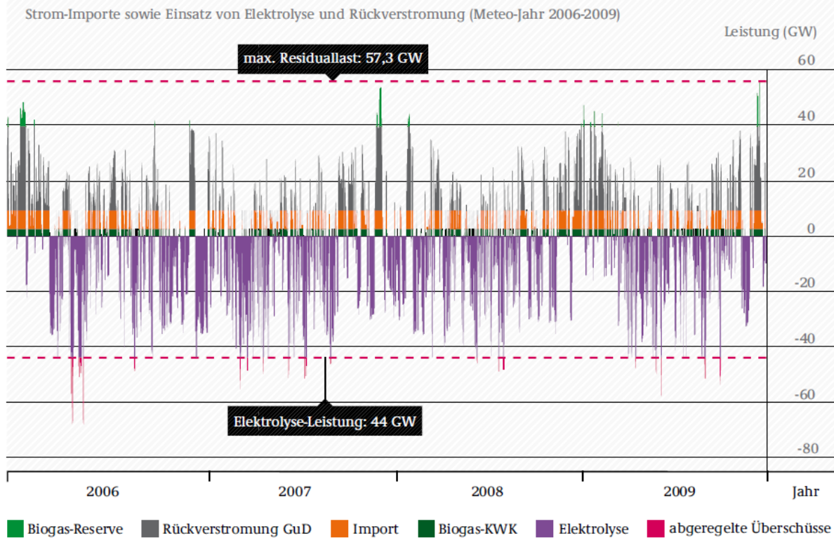
Bild 2: Residuallast bei 100 % Strombereitstellung aus erneuerbaren Energien im Jahr 2050: Defizite bei der Lastdeckung (oben); Überschüsse bei der Stromerzeugung (unten); Erfordernisse von Speicherkonzepten mittels Power-to-Gas-Konzepten (Wasserstoffherzeugung aus Überschussstrom über Elektrolyse sowie ggfs. Methanisierung und Rückverstromung mit GuD-Kraftwerken) [13]
